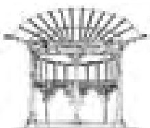
Alzados de la marquesina de vidrio y hierro del metro de Paris. Hector Guimard, 1899.
